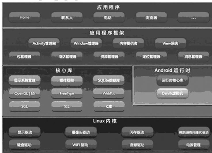
图 1-3 Android 系统框架
